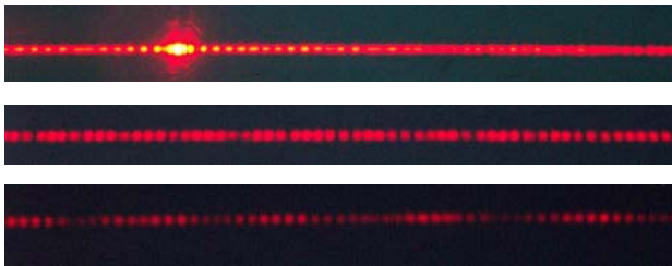
图 3 充满液体的毛细管的干涉
