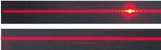
图7 毛细管干涉的等效点光源
